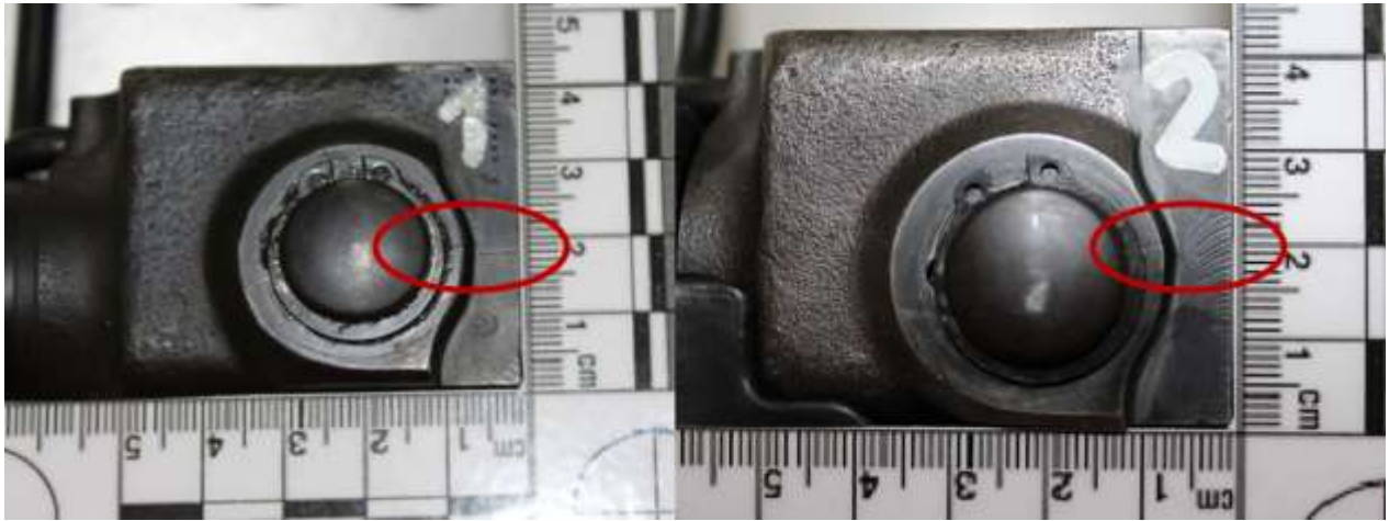
Photo1: Fissure de part en part
